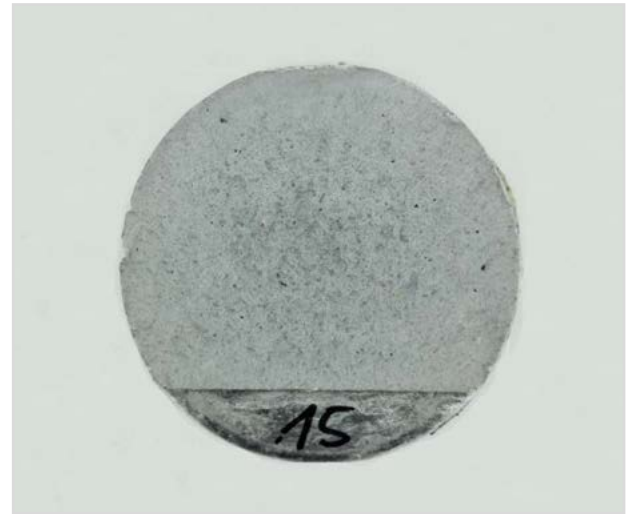
Bild 4: Aluminiumprobe für REM Untersuchung – nach Wärmebehandlung
