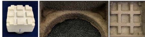
Abbildung 11: links: nicht beschichteter Sandkern; mitte und rechts: innere Gussoberfläche mit erheblicher Sandanhaftung.
