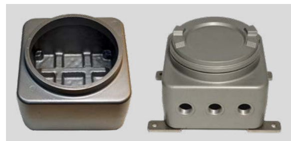
Abbildung 13: Innenseite des Gussteils (explosionsgeschütztes Instrumentengehäuse) nach Entfernung des beschichteten Sandkerns (mit freundlicher Genehmigung von Limatherm S.A. Polen).
