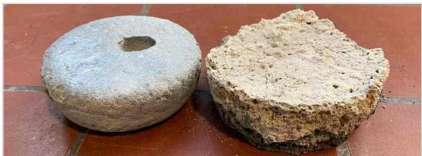
Bild 2: Metallphase und oxidhaltige Salzphase nach der Krätzeanalyse
