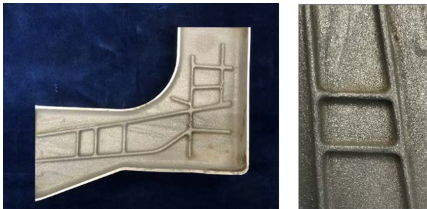
Abbildung 16: Die Innenfläche der Gussstücke nach Reinigung mit einem Hochdruckreiniger.
