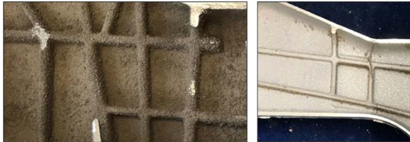
Abbildung 15: Innere Gussoberfläche nach dem Querschneiden der Gussstücke. links: nach dem Entfernen eines nicht beschichteten Sandkerns; rechts: nach dem Entfernen eines beschichteten Sandkerns
