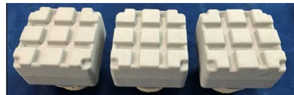
Abbildung 12: Sandkerne mit einer durch Tauchen aufgebrachten Beschichtung. Die Schichte wurde 1 Stunde lang bei 120\text{ °C} im Ofen getrocknet.
