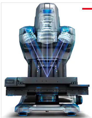
Erhitzungsmikroskop - Bestimmung der Hitzebeständigkeit verschiedener Füllstoffkombinationen
