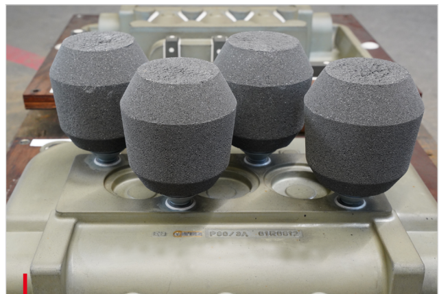
Modellplatte mit FEEDEX FEF VAK Speiser
