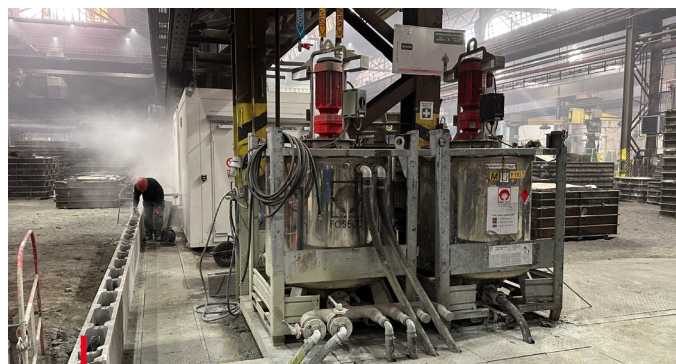
ICU-Pro mit Puffer - Automatisierung der Schlichte Aufbereitung und Anwendung
