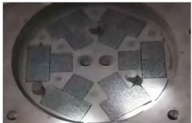
Abbildung 8: 18 Stück STELEX Pro 150x150x30/10 ppi, im Einsatz bei einer Rotornabe aus Gusseisen mit Kugelgraphit
