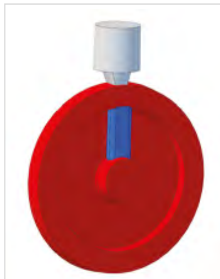
Abb. 2 Materialaufpolsterung, um einen Speisungspfad zu einer zentralen Materialanhäufung zu schaffen
