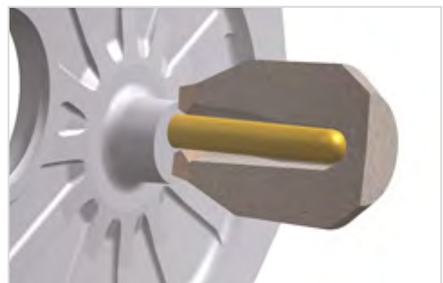
Abb. 3 Gussteil mit isolierter Nabe, gespeist durch einen Punktspeiser mit Sandbreckern
