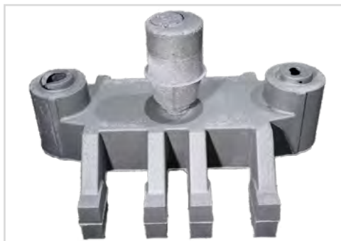
Abbildung 11. Das mit STELEX Optiflow3D und SCK Eingusspreiser gefertigte Gussteil
