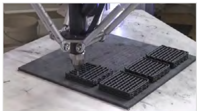
Abbildung 2: Forschung zur Herstellung von extrudierten 3D-gedruckten Filtern
