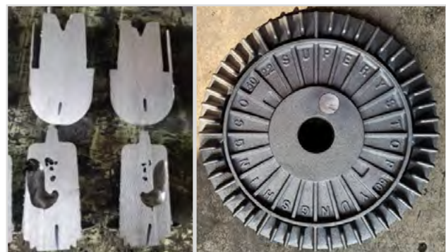
Abb. 12 a+b Fotos der gesägten Speiserreste und des Bauteils nach dem Trennen.
