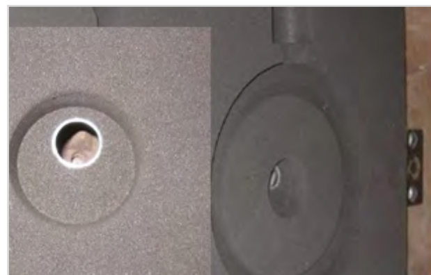
Abb. 5 Die Formergebnisse auf einer Prototypenplatte mit kompressiblen Metallbrechkern
