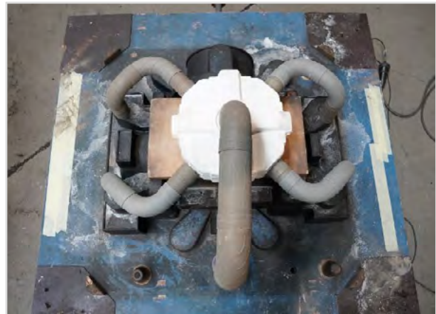
Abb. 3a+b: Fertig montiertes Gießsystem. Einfache Montage über Steckverbindungen
