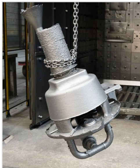
Abbildung 12. Der mit STELEX Optiflow3D hergestellte Planetenträger nach dem Ausleeren
