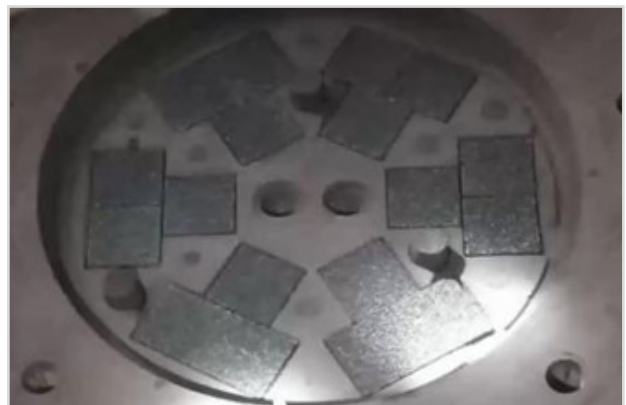
Abbildung 7: 18 Stück STELEX Pro 150x150x30/10 ppi in einer kritischen Anwendung von Gusseisen mit Kugelgraphit
