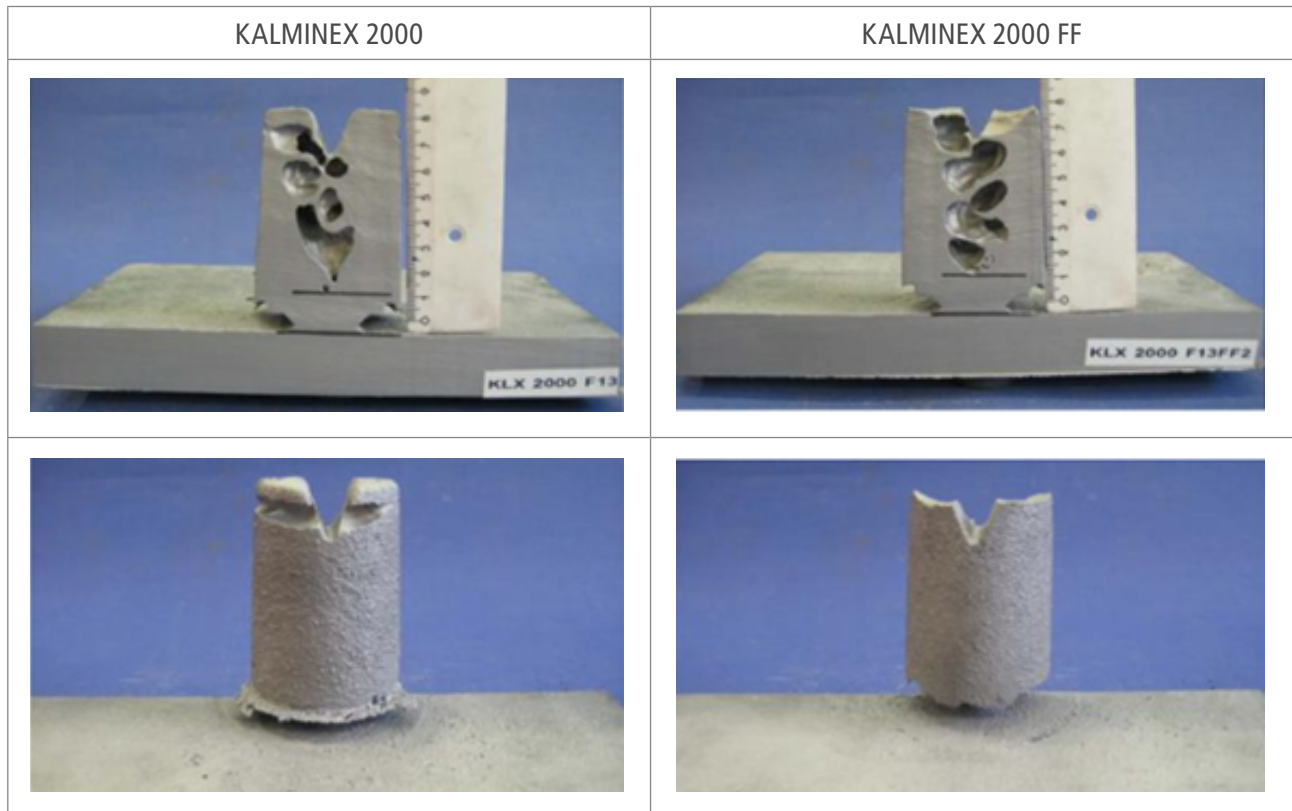
Abb 5a. Sphäroguss-Test mit KALMINEX 2000 ZP 6/9K/11Q gegen KALMINEX 2000 FF FZP 6/9K/11Q auf einer 250 x 250 x 25 mm Platte. Beide Speiser zeigten ein vergleichbares Speisungsvermögen.
