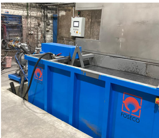
Abbildung 3: ICU-I - Integrierte Dichtheitskontrolle und -einstellung in einem kombinierten Flut- und Tauchbecken
