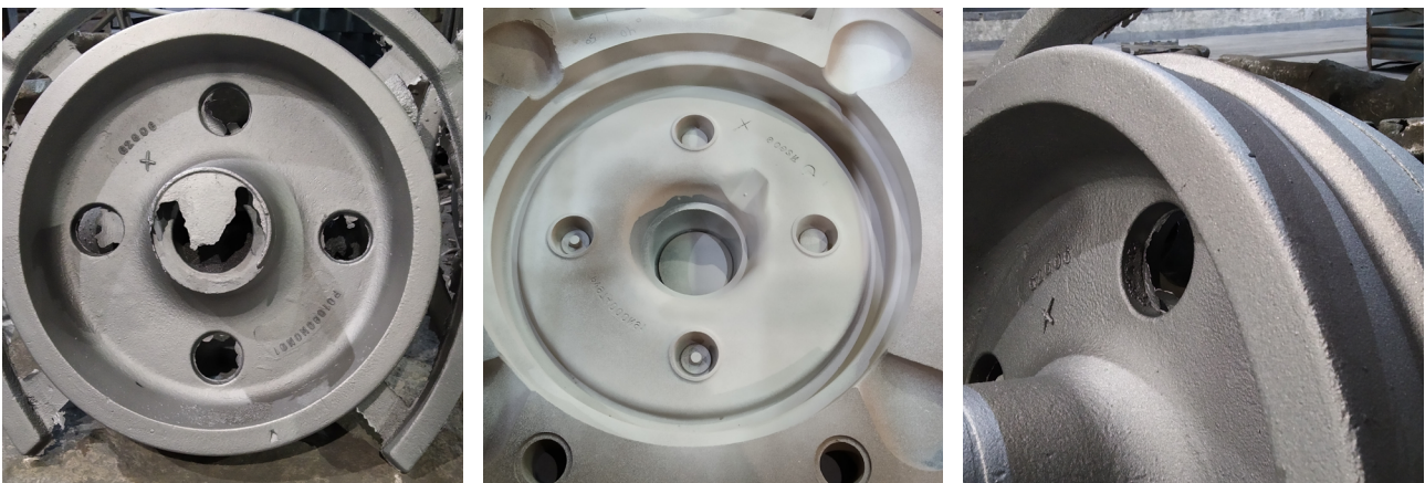
Abbildung 5. Ausgezeichnete Ergebnisse bei großen Gussstücken. Frei von Verkalkungen und mit guter Oberflächenqualität
