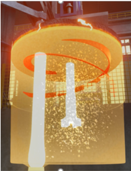
Abb. 3a: Sehr feine, spiralförmig verteilte Ar-Blasen
