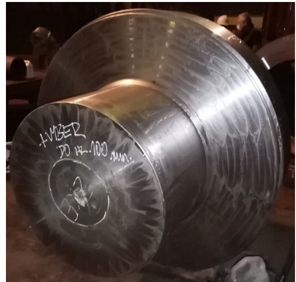
Abbildung 13a: Porosität in der unteren Nabe
