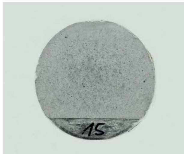
Bild 4: Aluminiumprobe für REM Untersuchung – nach Wärmebehandlung
