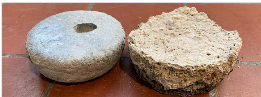
Bild 2: Metallphase und oxidhaltige Salzphase nach der Krätzeanalyse
