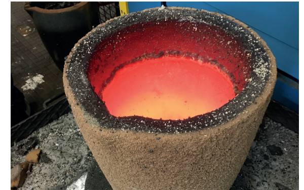
ENERTEK ISO Tiegel nach dem Gießen
