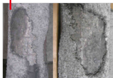
Saubere Oberflächen bei HOLLLOTEX EG Runner ST im Stahlguss
